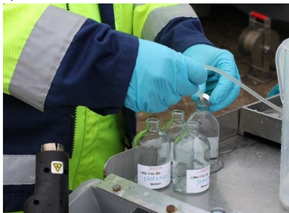
Abb. 7: a) Grundwasserprobenahme mittels Tauchmotorpumpe MP1 (Foto: Roskam, NLWKN), b) Grundwasserentnahme zur Gas- und Isotopenanalyse durch einen LBEG-Mitarbeiter.
