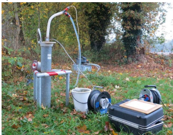
Abb. 7: a) Grundwasserprobenahme mittels Tauchmotorpumpe MP1 (Foto: Roskam, NLWKN), b) Grundwasserentnahme zur Gas- und Isotopenanalyse durch einen LBEG-Mitarbeiter.
